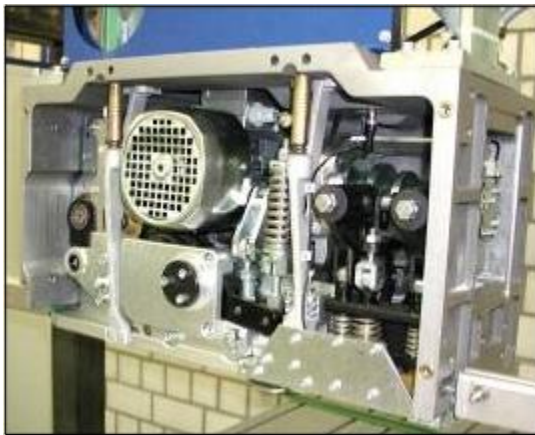
FROMM páskovací hlava model MH600 na vysoké napnutí a frikční svar; zavěšení hlavy s „plovoucím“ systémem
