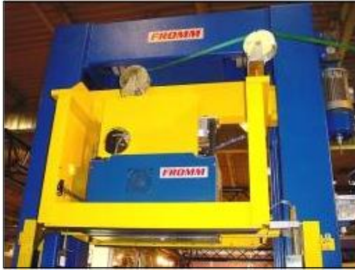
Dvojitý lis stlačující ingotovou vrstvu na obou stranách páskovací linky
